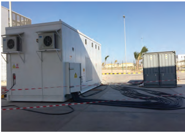
Insitu Genset Load test upto 3,500 KVA, 415V /11KV / 6.6KV @pf 0.8 or 1.0
